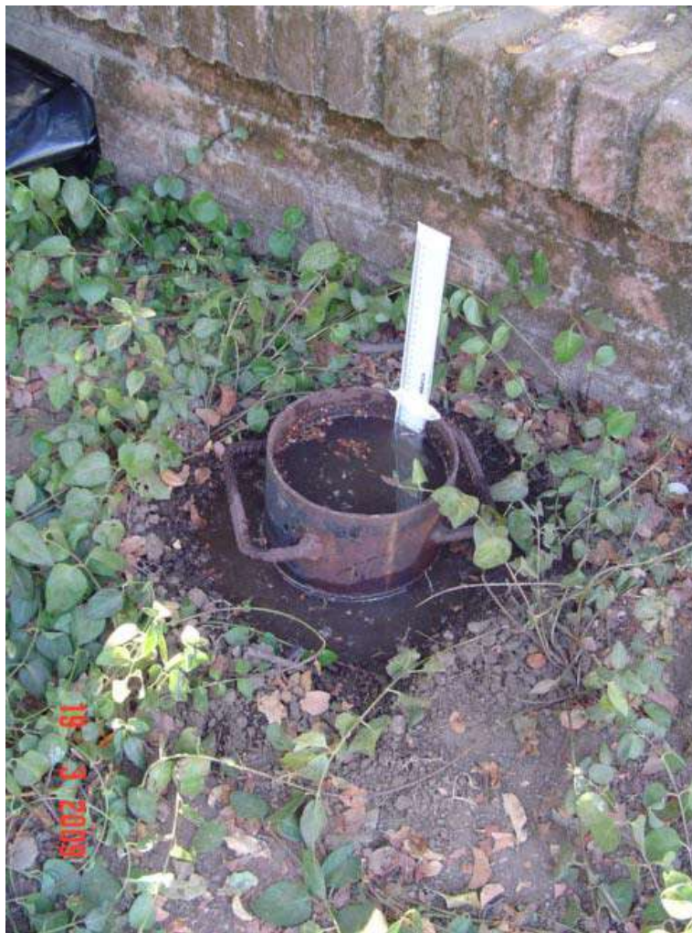
Fotografía prueba de infiltración sector jardines de Alto Mantagua.
